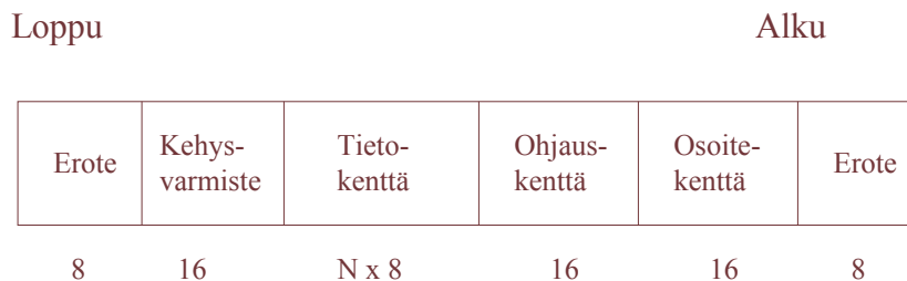
Kuva 2.2. Siirtoyhteyserroksen I-kehyksen kehysrakennetta
