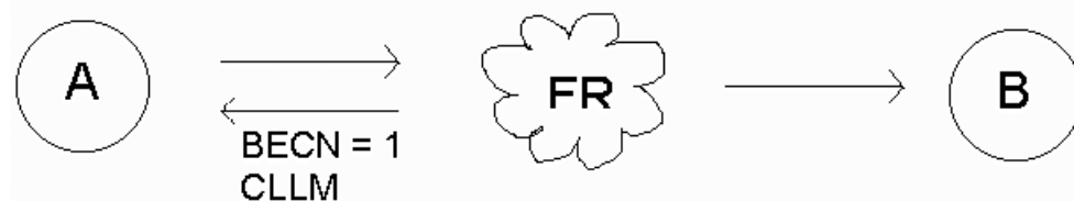
Kuva 3: BECN:n lähetys. Verkossa on ruuhka ja verkko lähettää BECN kehyslähteeseen. A:n on vähennettävä tiedon määrää.
