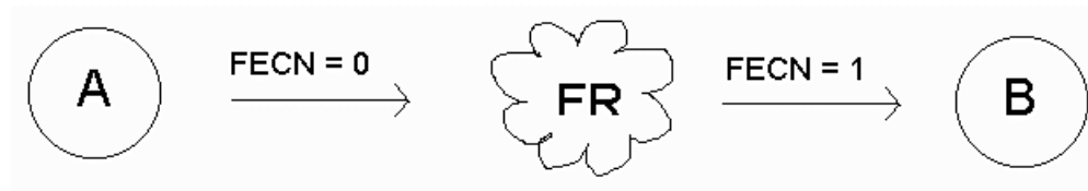
Kuva 4: FECN:n lähetys. Verkossa on ruuhka ja vastaanottaja B huomaa sen. Korkeampi sovelluskerros lähettää komento A:lle, että tiedon määrä on vähennettävä.
